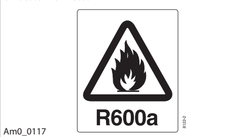
Рис. 6. Этикетка на компрессоре, работающем с хладагентом R600a
